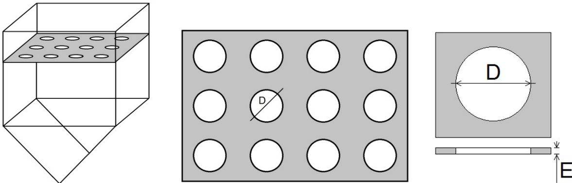
Deve-se medir **COM PAQUIMETRO** o diâmetro "D" e a espessura "E" do furo para um perfeito encaixe da manga. Recomenda-se realizar 3 medições (d1, d2 e d3) no mesmo furo e considerar a média destas medições.
