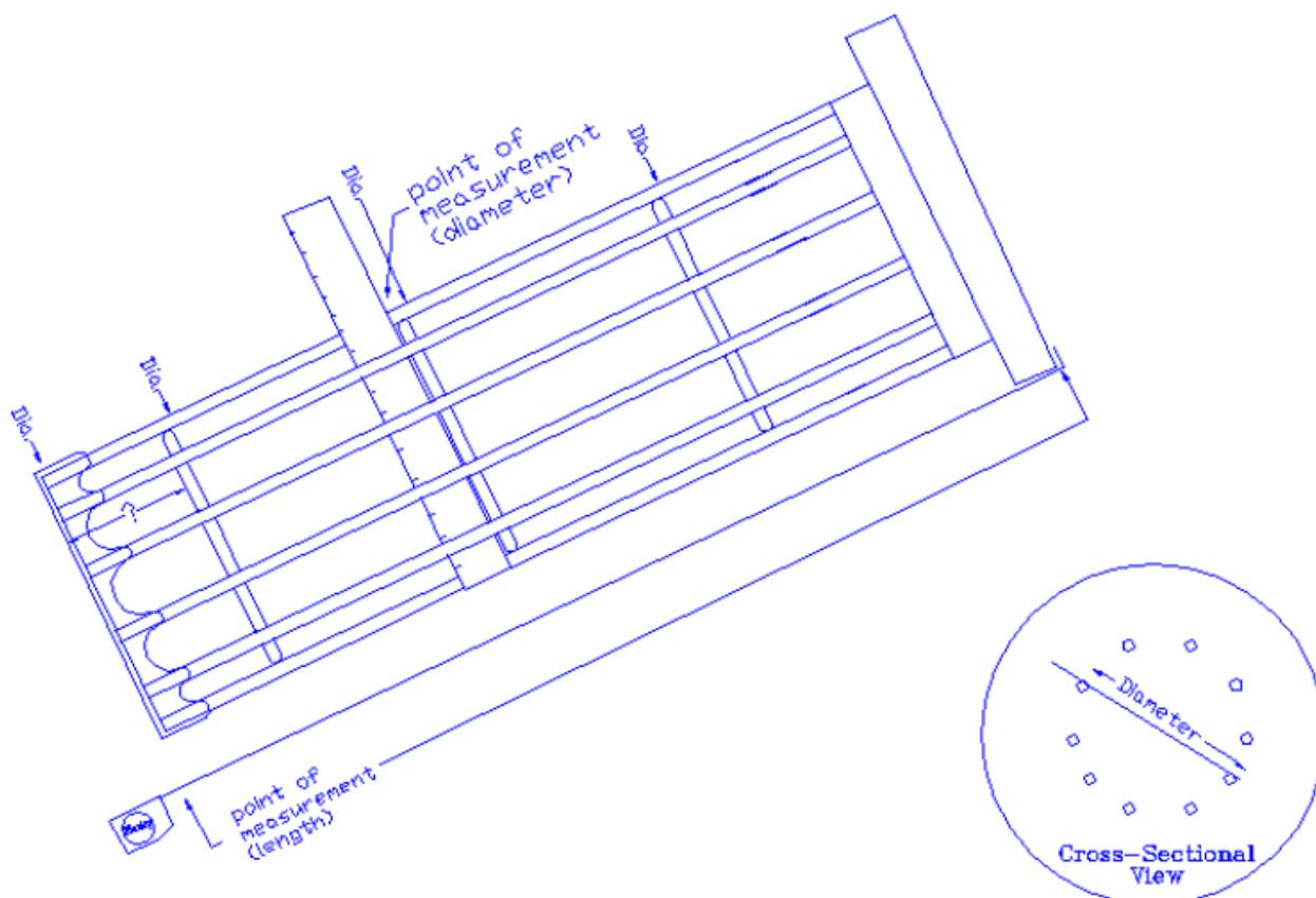
Deve-se medir **COM PAQUIMETRO** o diâmetro e com uma trena ou fita métrica o comprimento, recomenda-se medir ao menos 3 gaiolas para verificação da uniformidade das mesmas. Tolerância de +/- 0,25mm no diâmetro e +/- 5mm em seu comprimento, **não escolher gaiolas empenadas para aferição do dimensionamento.**
